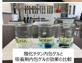
作成した酸化チタン内包ゲル
